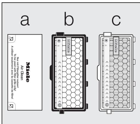
1. Si desea reemplazar el **a** filtro Air Clean con el **b** filtro ActiveAirClean 50 o el **c** filtro HEPA AirClean 50, debe quitar el marco del filtro antes de colocar el filtro nuevo.
