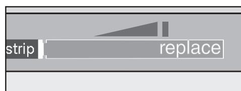
Después de unas 50 horas de operación, lo que corresponde al uso promedio de un año, se ilumina el indicador. A continuación puede continuar con la succión. Recuerde, sin embargo, que disminuye la aspiración y la eficiencia de filtración.
